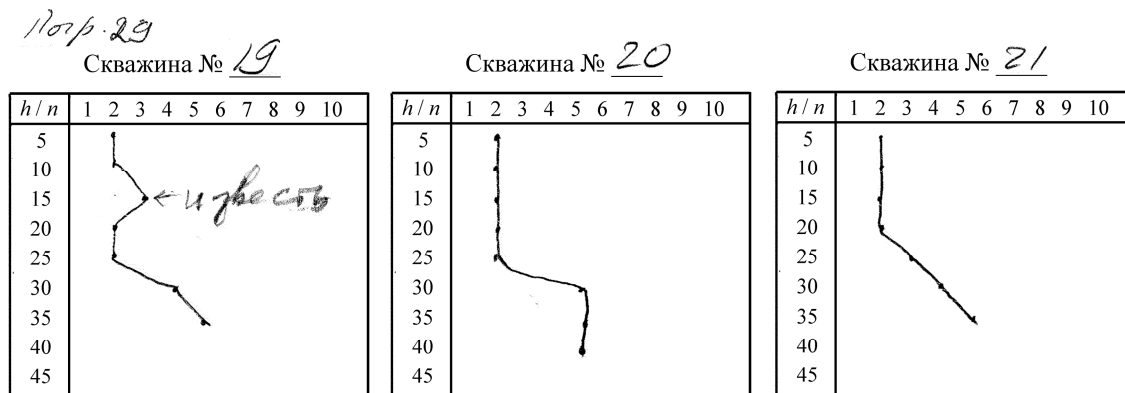
Рис. 5. Полевой протокол зондирования скважин 19–21 (горизонтальная ось – количество ударов зонда, вертикальная – заглубление, м): на скважине №19 отмечена аномалия
