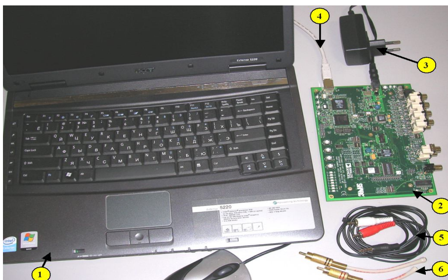
Рис. 1. Внешний вид установки для исследования алгоритмов цифровой обработки звуковых сигналов
